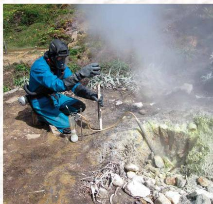
Prélèvement de gaz par l'OVSG au sommet de la Soufrière © OVSG/PGP, 2015
